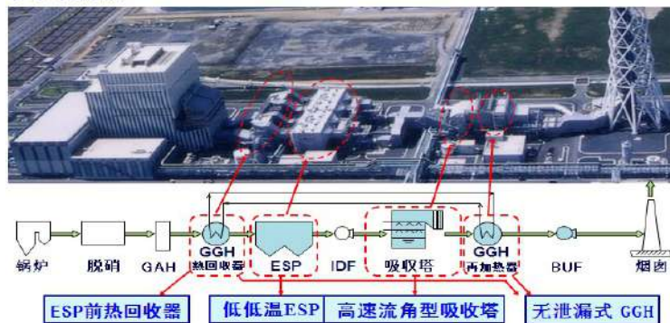
日本低低温电除尘系统布置
